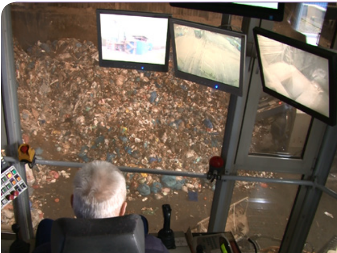
Zwei FLIR FC-Serie R-Kameras überwachen die gesamte Oberfläche des Müllbunkers (25 x 25 m).
